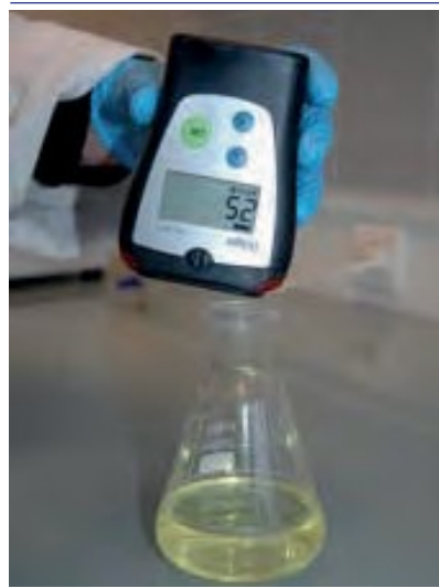
Mesure des vapeurs avec un explosimètre.
